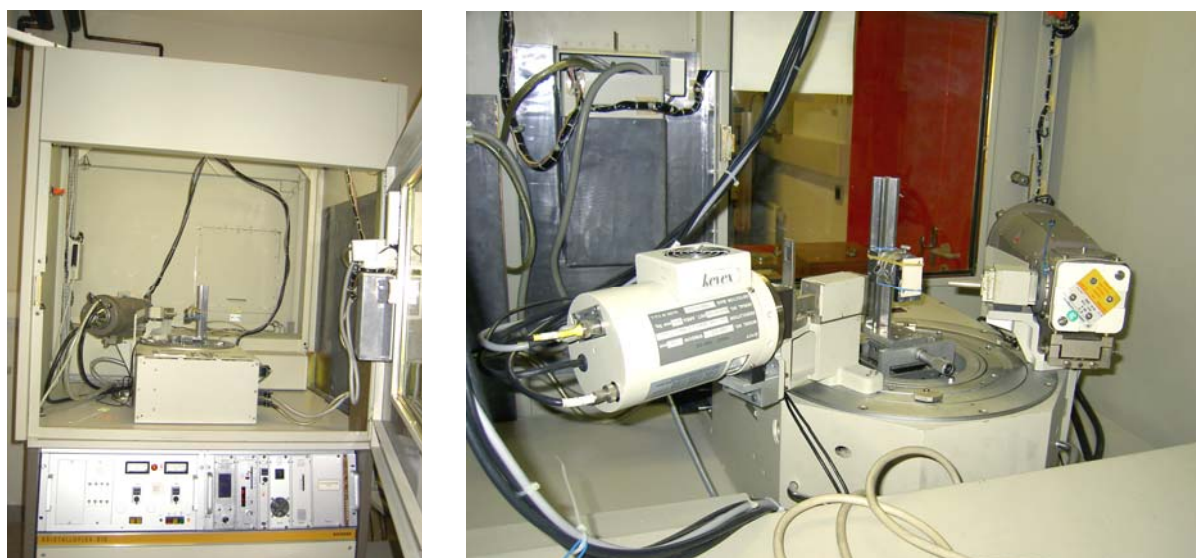
Figure A.1 : Diffractomètre SIEMENS D500.
